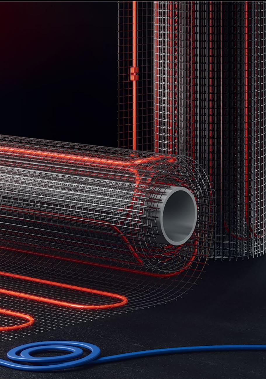
Теплый пол Voltum представлен в двух сериях двухжильных нагревательных матов (Т150 и Т200) длиной от 1 до 30 м и мощностью 150/200 Вт. Предназначен для автономного и/или вспомогательного отопления помещений, устанавливается в слой плиточного клея или стяжку.
