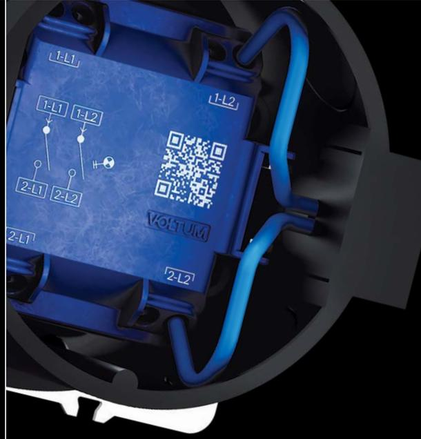
Вывод проводов подключения расположен под углом к задней поверхности механизма, что позволяет предотвратить перегиб провода в подрозетнике и обеспечивает долговечность и безопасность эксплуатации.
